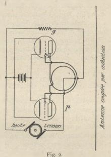
fonctionnements très stables sur des ondes de 1<sup>m</sup>50. Sur cette onde nous avons pu mettre 0,46 dans l'antenne couplée inductivement avec le générateur; ce qui correspond à une puissance rayonnée d'une trentaine de watts.
