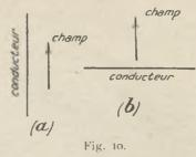
l'antenne de réception est verticale, elle est excitée, la lampe s'allume; quand l'antenne de réception est horizontale, il n'y a aucune excitation, la lampe s'éteint.
