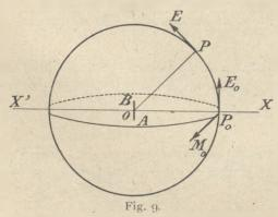
les points de l'espace situés dans le plan XX' perpendiculaire au milieu de l'antenne, ce champ  $E_0$  est parallèle à l'antenne. Le champ magnétique  $M_0$  est aussi perpendiculaire au rayon  $\mathrm{OP}_0$  et il est horizontal, mais il n'y a pas à s'en occuper dans les expériences qui suivront.
